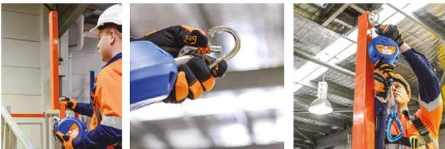
Das HSG wird mit einem Schraubkarabiner verbunden. Nach dem Schließen wird der Karabinerhaken bis zum Ende seines Weges geschraubt, um ein versehentliches Öffnen zu verhindern.
