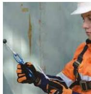
12. Verbinden Sie das HSG mit dem Ganzkörpergurt - wobei Sie die drei Kontaktpunkte einhalten.
